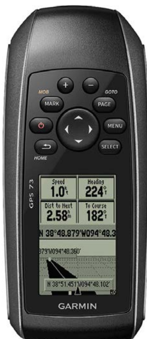
Rys. 4.4. Garmin GPS 73 – urządzenie rejestrujące trasę rejsów badawczych
