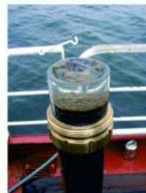
Osad pobrany sondą rdzeniową
